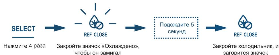
Выключение функции выключения охлаждения холодильной камеры
