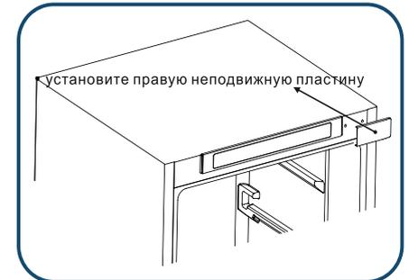
Установите переднюю верхнюю пластину. Закрепите переднюю верхнюю пластину в передней верхней части холодильника с помощью винтов.
